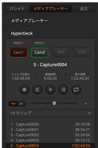
HyperDeckパレットのボタンを使用して最大4台のHyperDeckを選択
